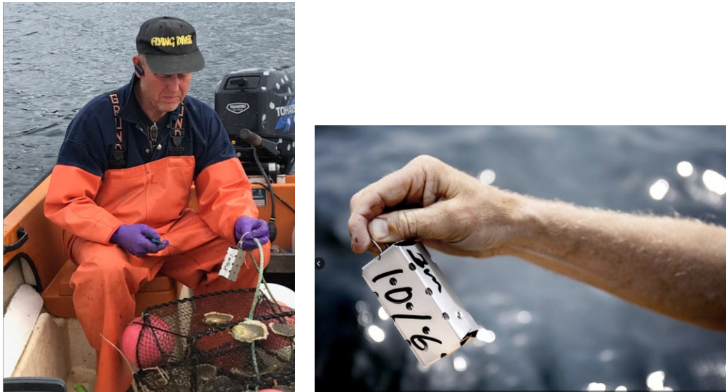
Figur 8. SPMD-provtagare innehållande membran. Dessa sattes fast på linan 25cm ovanför burarna för att mäta PAH-halterna i vattnet.
